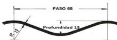
Figura 1. Dimensiones de la corruga 68 mm x 13 mm
