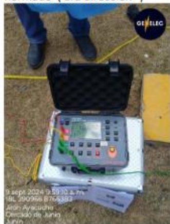
Medicion aislado mayor a lo normado ( 1ra direccion )
