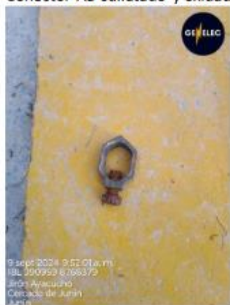
Conector AB sulfatado y oxidado
