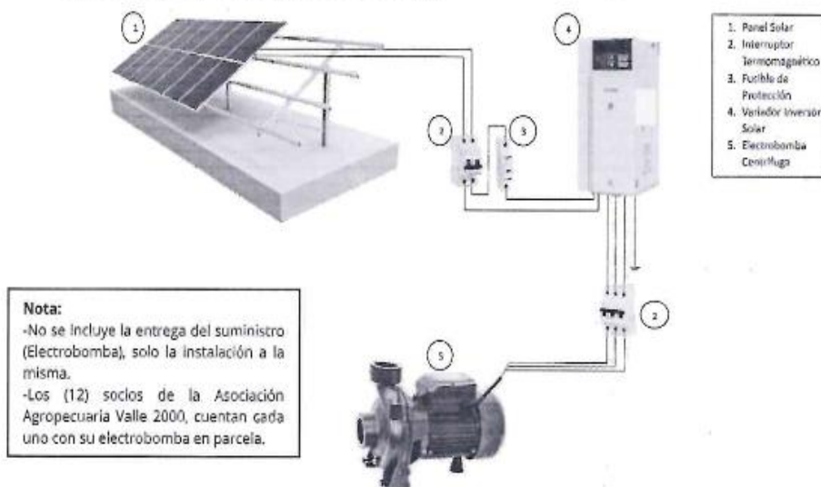
Imagen 01: Diagrama referencial para realizar la instalación eléctrica.
