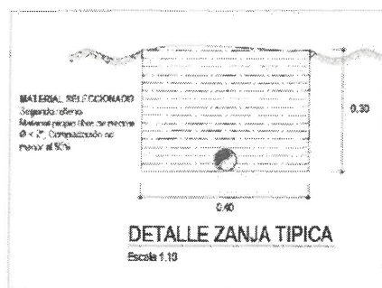
Imagen 72. Zanja típica de la línea de aducción.
