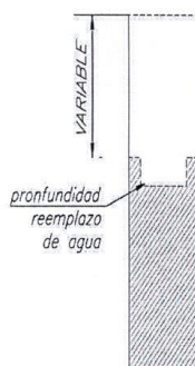
Figura 3. Ejecución del ensayo de reemplazo de agua en el interior de una excavación
