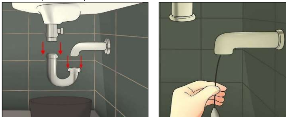
Ilustración 33 limpieza de la trampa “P” del lavatorio
