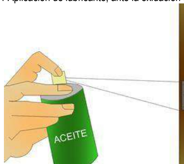
Ilustración 41 Aplicación de lubricante, ante la oxidación o ruido de las bisagras
