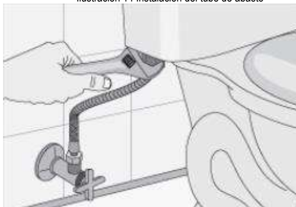
Ilustración 14 Instalación del tubo de abasto
