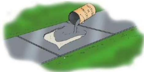
Ilustración 38 Vertimiento de la lechada de cemento
