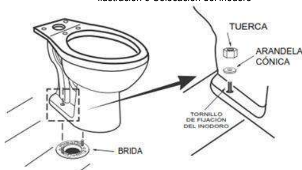
Ilustración 6 Colocación del inodoro
