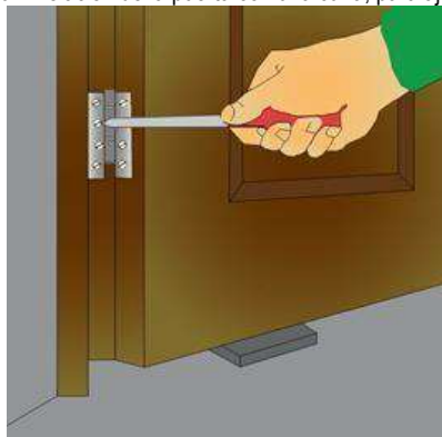
Ilustración 40 Nivelación de la puerta con una cuña, para ajustar bien las bisagras
