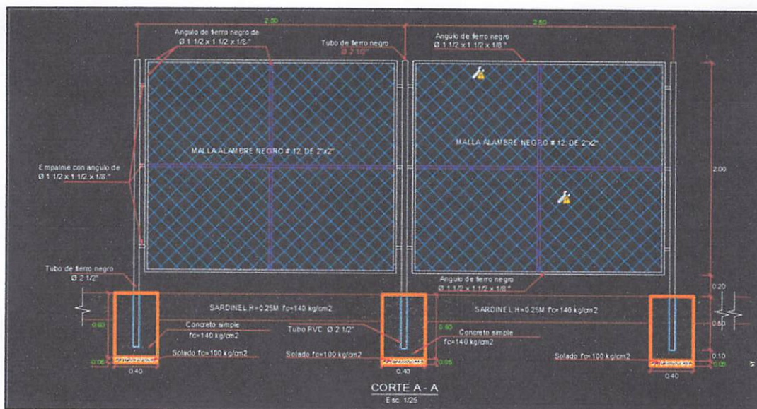
Imagen n°12. Plano de los detalles del cerco perimetrico proyectado.
