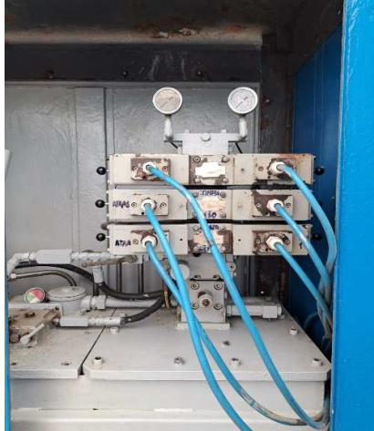
Figura 9. Referencia 06 cables alimentación 24Vdc control electroválvulas direccionales
