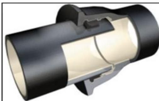
El material del anillo por estar en contacto con aguas agresivas será en NBR que permita establecer un sello flexible y de larga duración que sea resistente a los esfuerzos mecánicos, ataque químico o bacteriológico, que aumente la garantía y desviación angular permisible durante el enchufado y que garantice la estanqueidad por la compresión radia del anillo de junta durante todo el tiempo que la canalización este en servicio.
