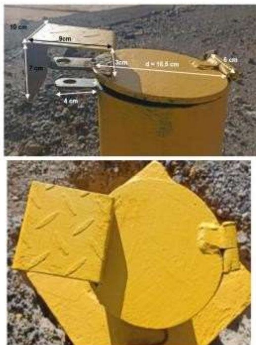
Medidas de la tapa del piezómetro GW-5(A/B)
