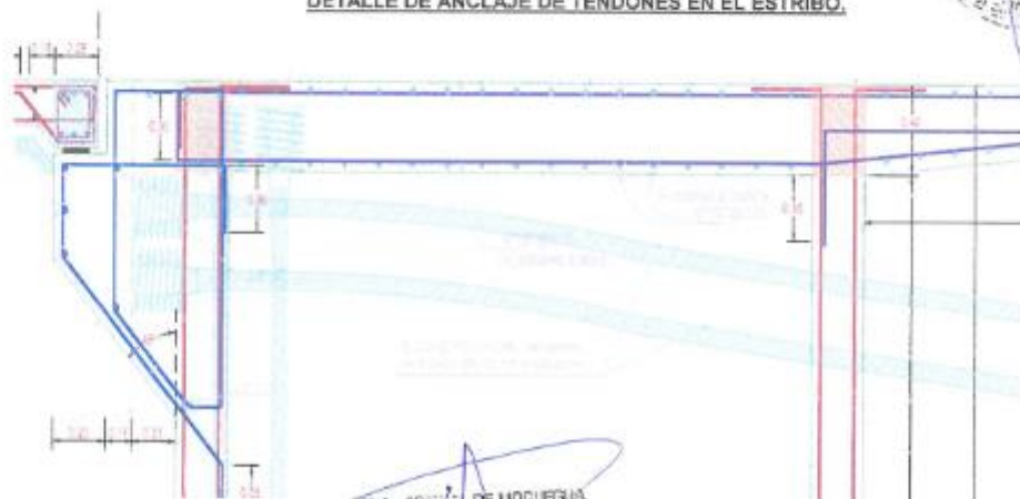
DETALLE DE ANCLAJE DE TENDONES EN EL ESTRIBO.
