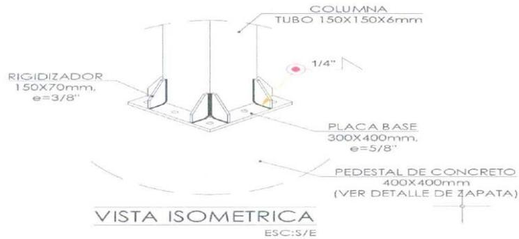
Para el anclaje de las columnas se tomará en consideración los detalles expuestos en los planos y que se adjuntan en las imágenes lo que da detalles de la forma como se realizaran los trabajos de soldadura y las consideraciones técnicas para un buen desarrollo de los procesos constructivos
