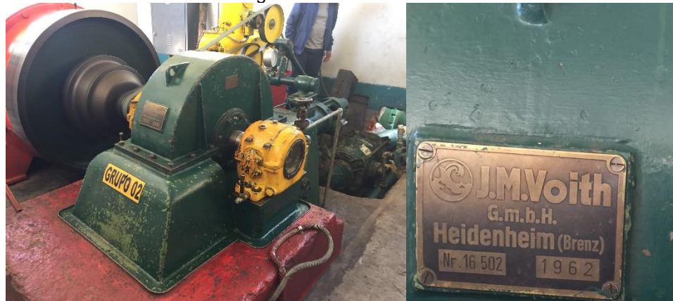
Figura 2: Turbina Pelton
