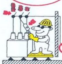
3. Verificar la ausencia de tensión.
