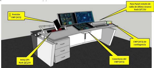
Figura 3: Posición de los paneles de último recurso radio en las posiciones de control
