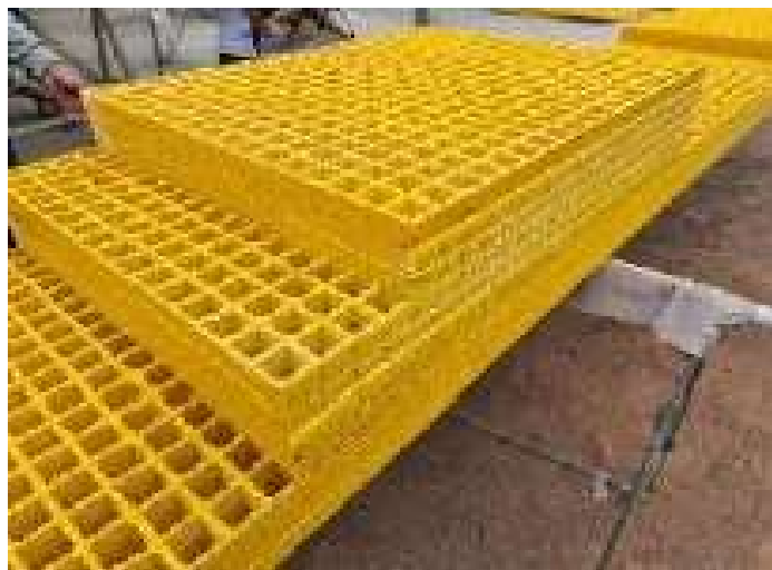
Parrillas de fibra de vidrio antideslizante, de 1m de ancho x 38 mm. Color amarillo RAL 1003
