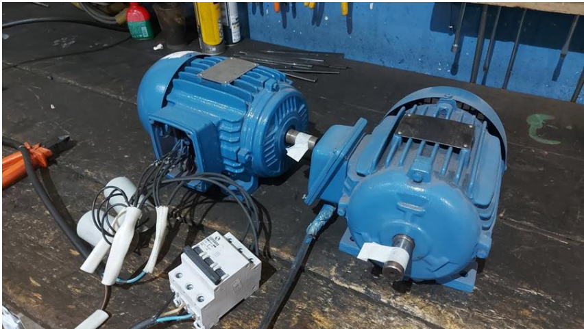
ANEXO 02: MOTOR ELECTRICO TRIFASICO DE 5 HP
