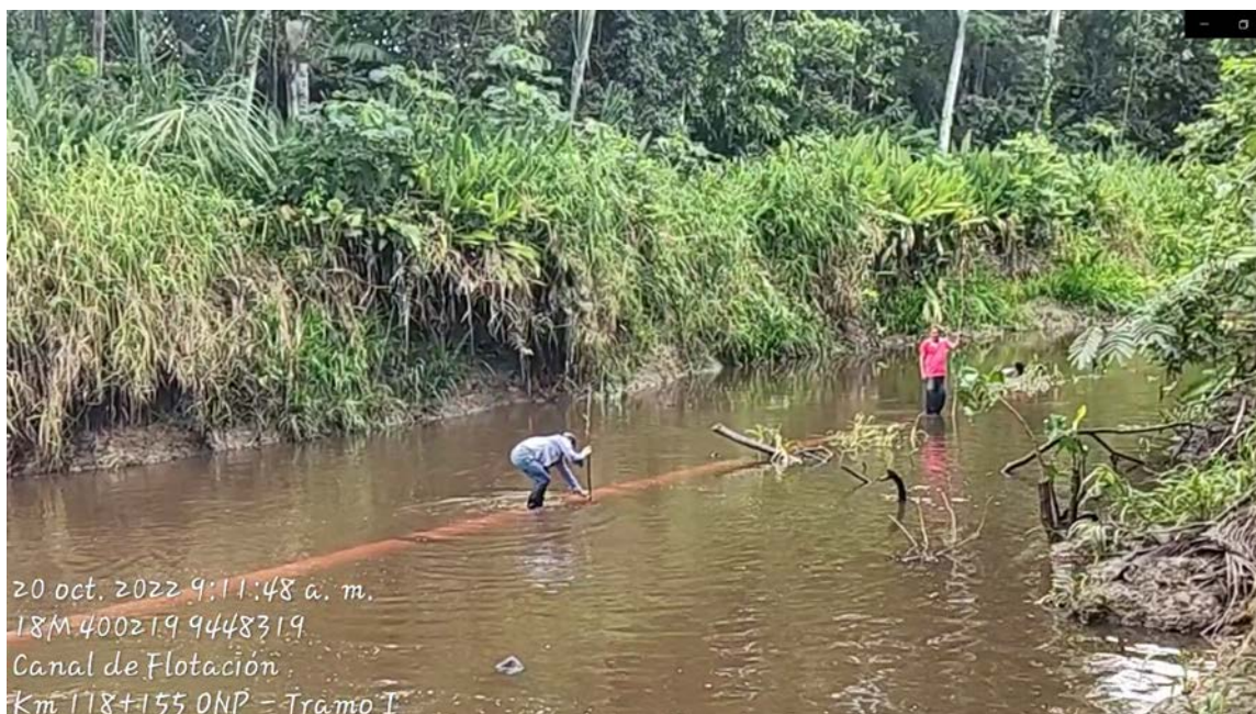
Foto N° 1.5- Determinación del nivel de socavación del fondo del canal de flotación, respecto el lomo superior de la tubería. (Fecha 20.10.2022)
