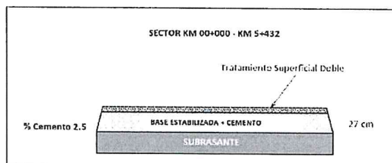
Figura 2. Sección del Pavimento
