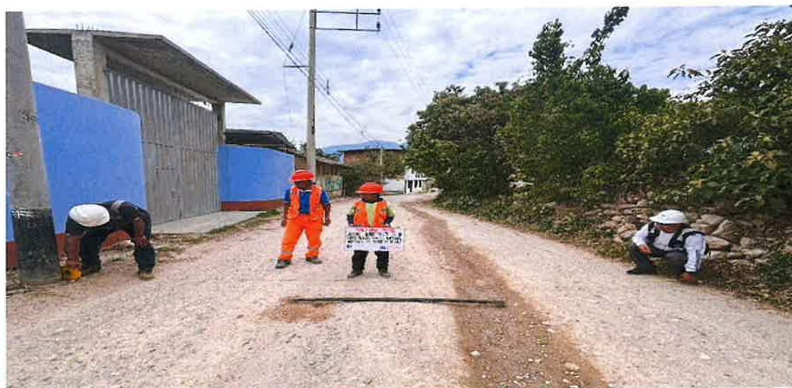
Foto N° 2: Medidas en la superficie de rodadura, progresiva 00+250
