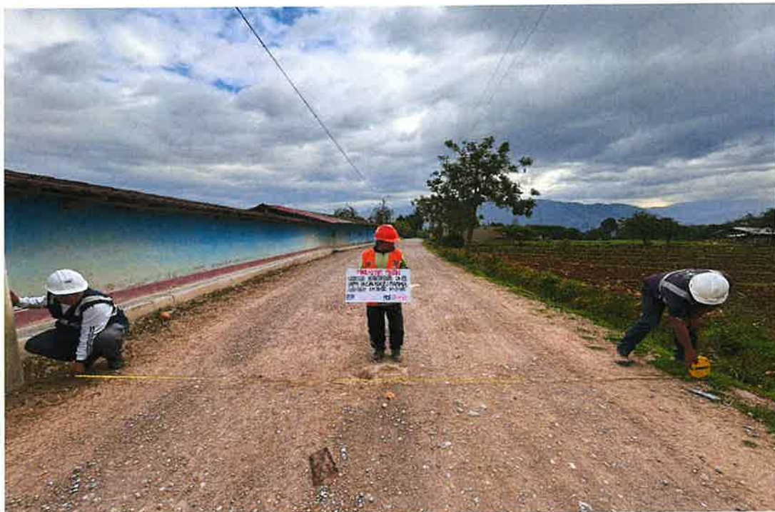
Foto 19: Medidas en la superficie de rodadura, progresiva 04+500
