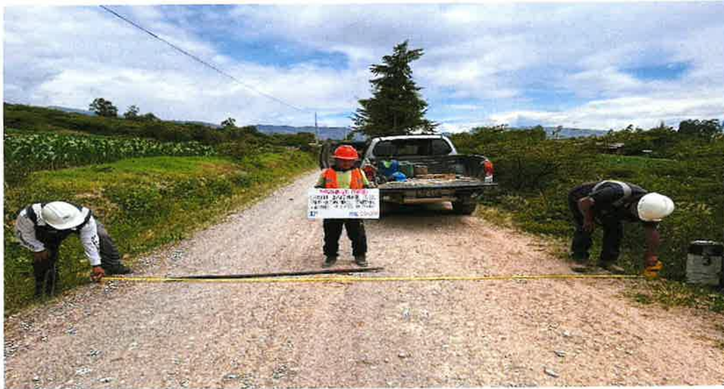
Foto 13: Medidas en la superficie de rodadura, progresiva 03+000, hito
