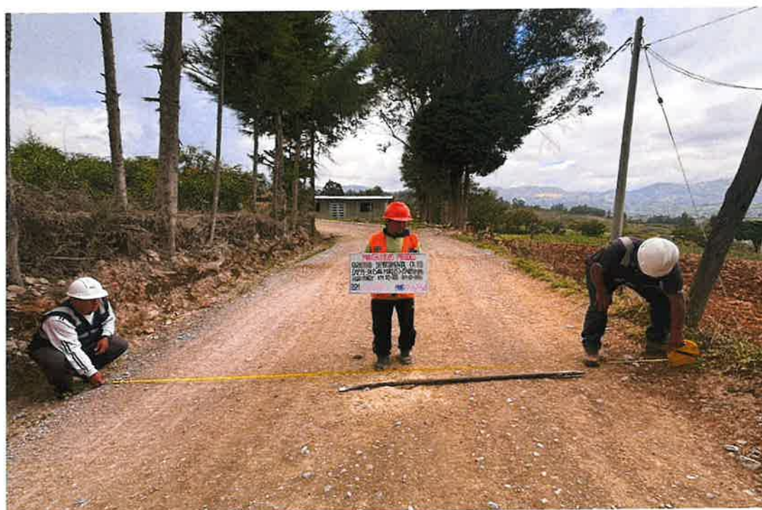
Foto 18: Medidas en la superficie de rodadura, progresiva 04+250
