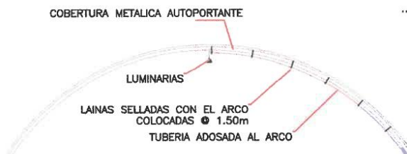
COLOCACION DE LAINAS EN EL ARCO
