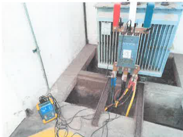
Fig. 22: Instalacion del analizador de redes en las instalaciones del cliente.
