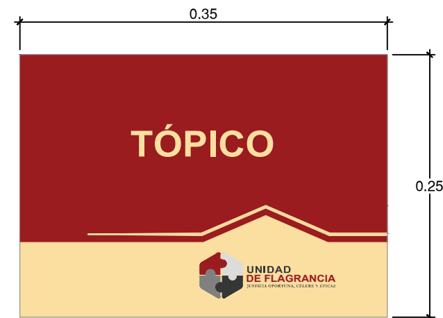
DETALLE DEL LETRERO DE TÓPICO (TIPO ADOSADO - 1 UNIDAD) ESCALA 1/5
