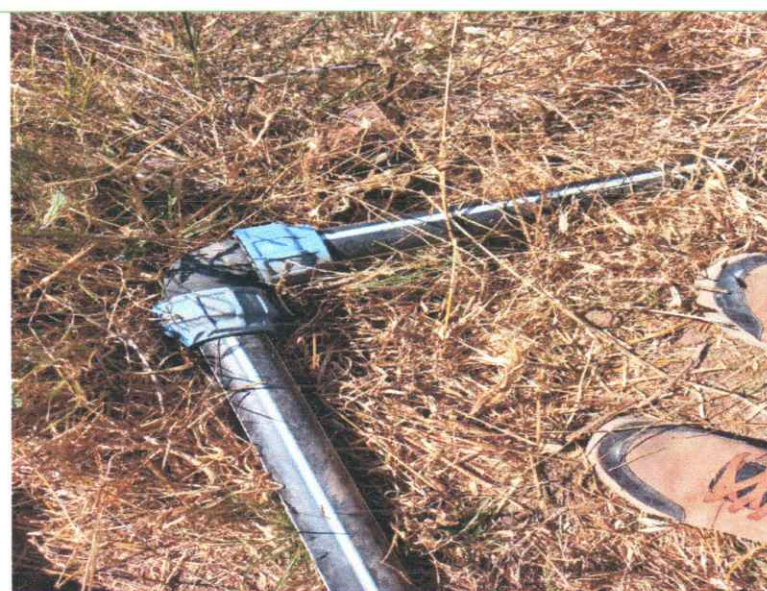
Fotografía N°07: Manguera Hdpe con accesorio
