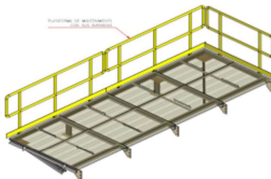
Fig. N°05 Plataforma de mantenimiento, con barandas
