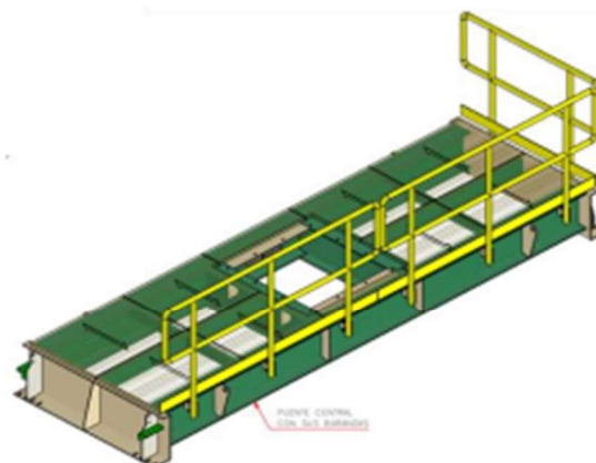
Fig. N°04 Puente central del Tanque de neutralización, con barandas
