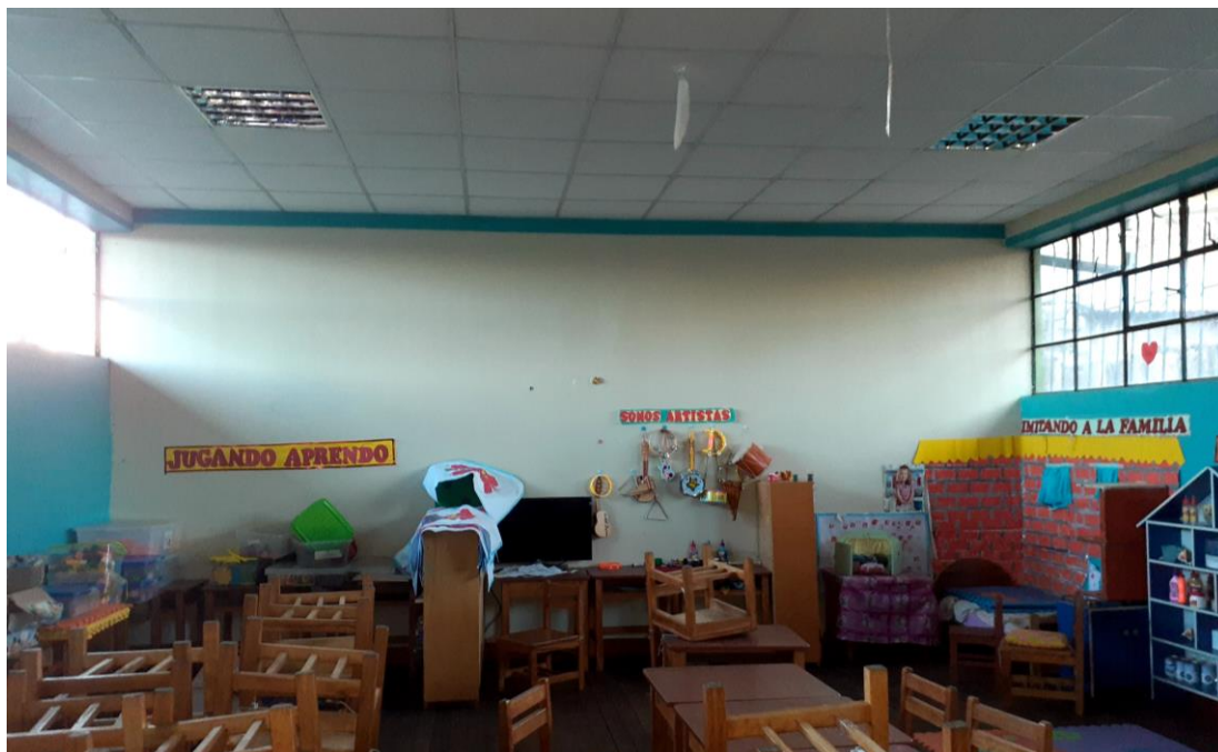
FOTO 16: Imagen corresponde al interior del aula N° 2 (Pabellón II). Los muros y el acabado se encuentran en buen estado de conservación, El falso cielo raso es de baldosas acústicas, el piso y el contra zócalo es de madera y se encuentran en buen estado de conservación.
