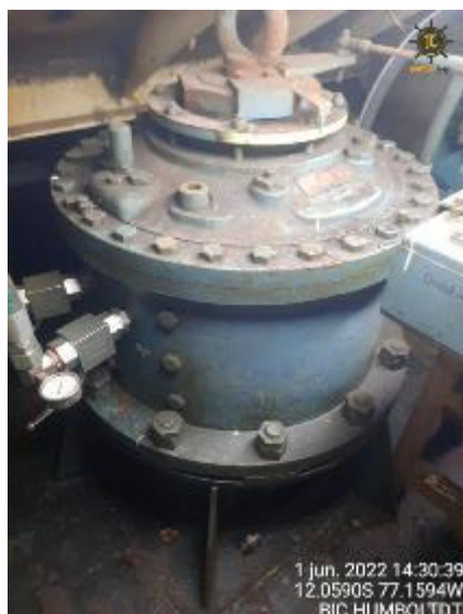
65&66. Servomotor en buenas condiciones.
