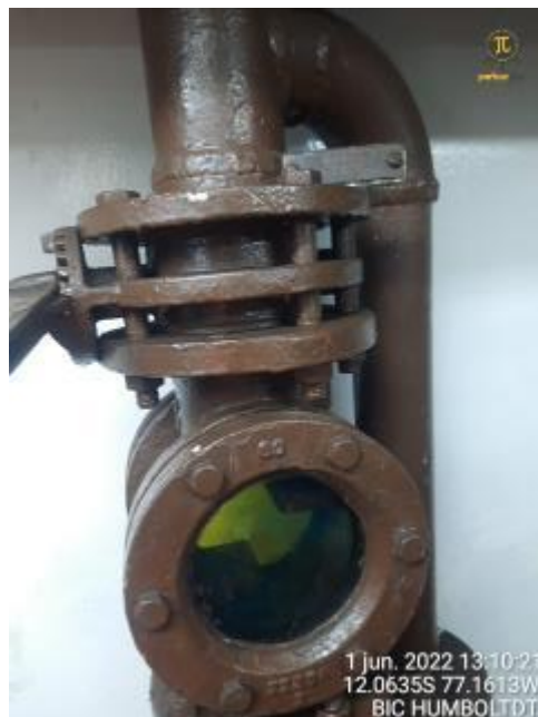
41&42. Tuberías corroídas y signos de líquidos en la sentinas de sala de maquinas y visor de combustible.
