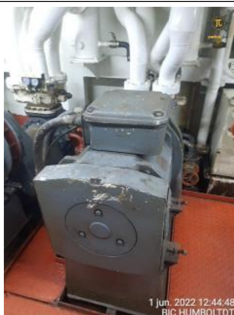
33&34. Motores hidráulicos
