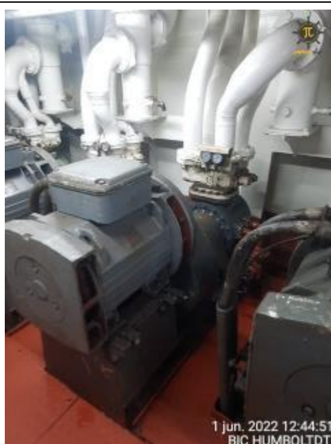
33&34. Motores hidráulicos
