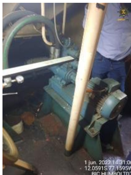
65&66. Servomotor en buenas condiciones.
