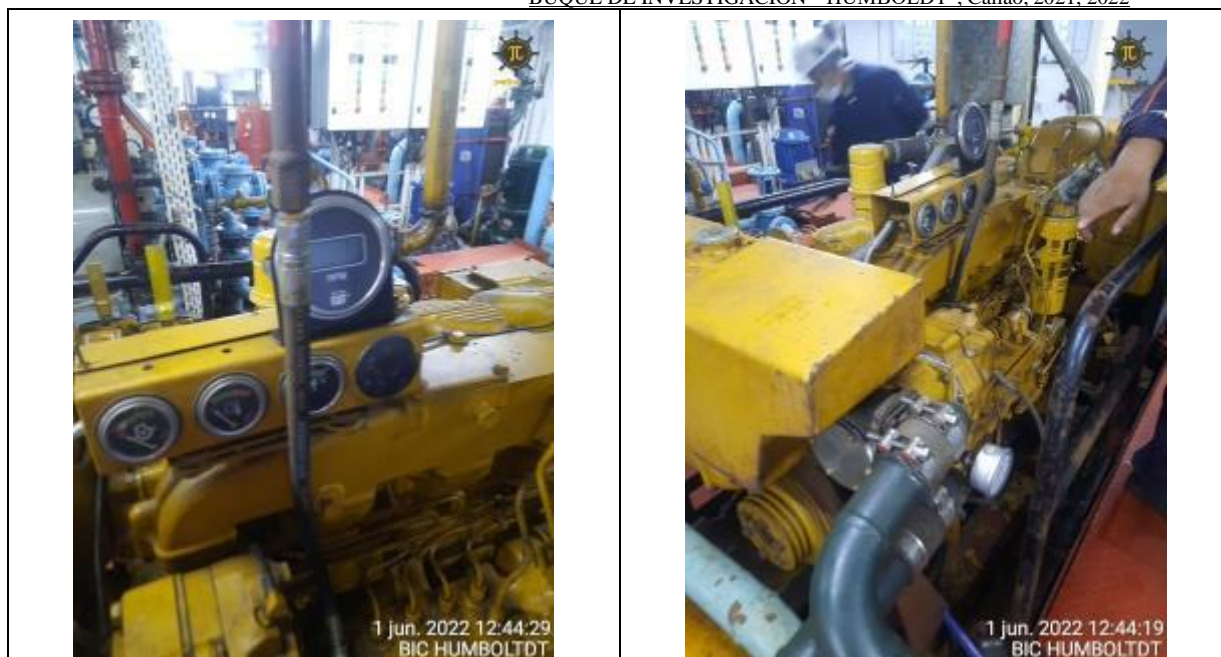
25&26. Motor auxiliar Bravo fuera de servicio
