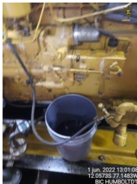
39&40. Fuga de aceite en el gobernador del motor auxiliar Charlie.
