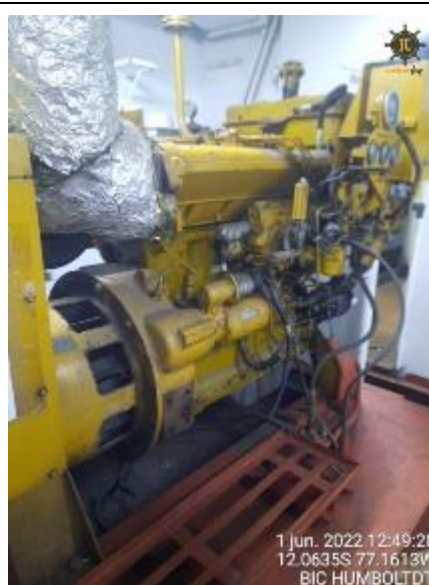
35&36. Maquina auxiliar de puerto fuera de servicio
