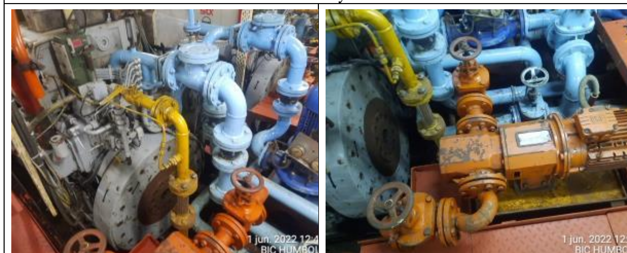
29&30. Bomba de lubricación del motor principal Er.
