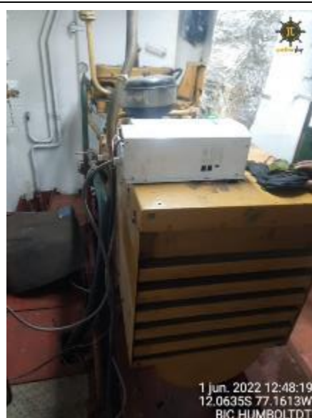
35&36. Maquina auxiliar de puerto fuera de servicio
