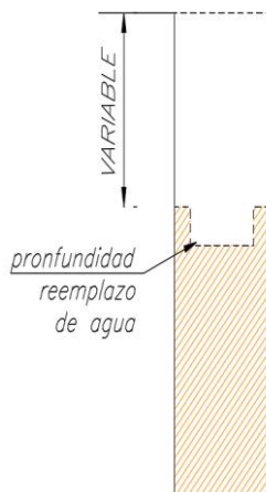
Figura 19 Ejecución del ensayo de reemplazo de agua en el interior de una excavación
