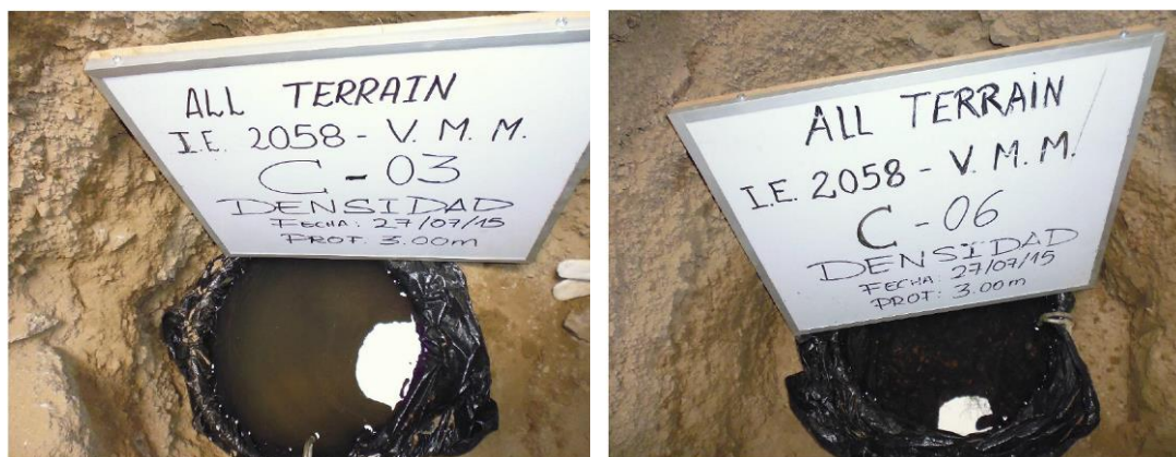
Figura 18 Ejecución de ensayo reemplazo de agua
