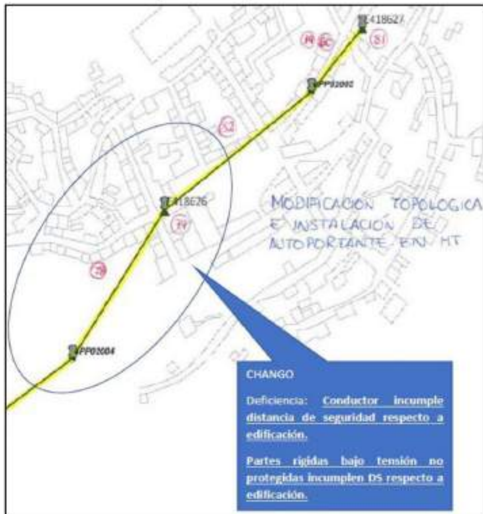
Fig. N° 18 DMS a mejorar en el alimentador A4941
