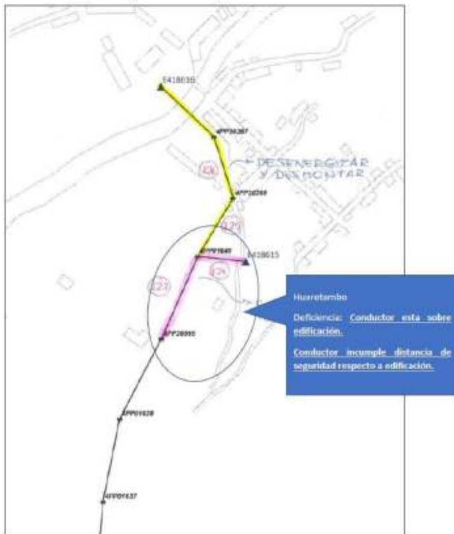
Fig. N° 20 DMS a mejorar en el alimentador A4941
