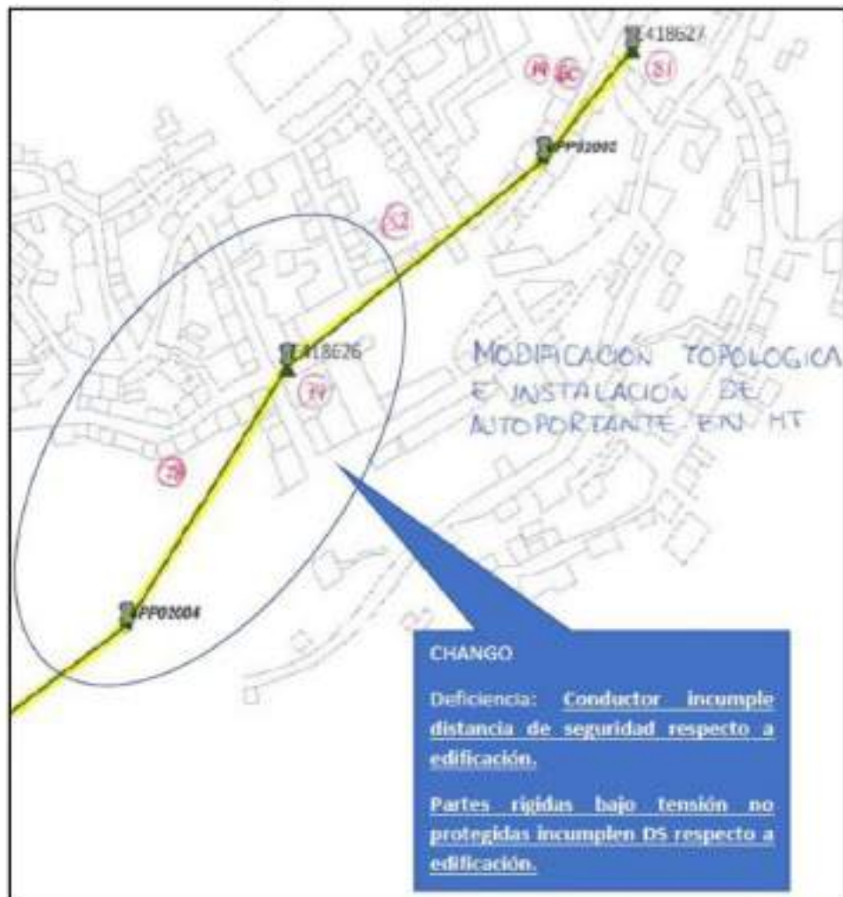
Fig. N° 40 DMS a mejorar en el alimentador A4941
