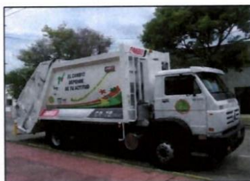
Camiones Compactador de RRSS de diferentes capacidades
