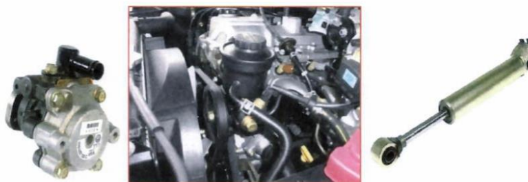
Bomba de la Dirección, Mangueras Hidráulicas y Cilindro de Asistencia
