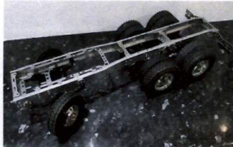
Bastidor de un chasis de camión 6x4
