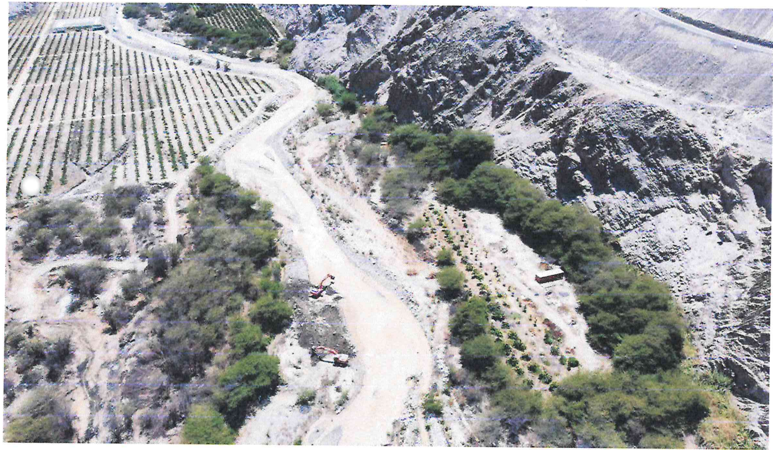
FIGURA N°03: SEDIMENTACION EN EL CANAL Y COLMATAACION
