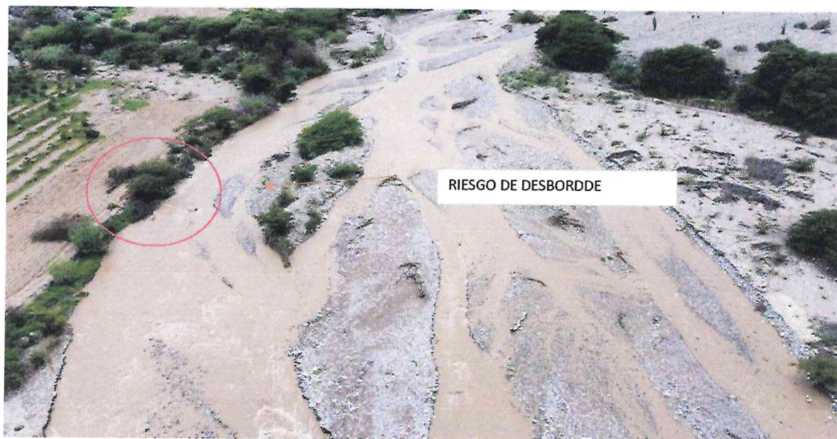
FIGURA N°02: Tramo colmatado en el Recorrido
