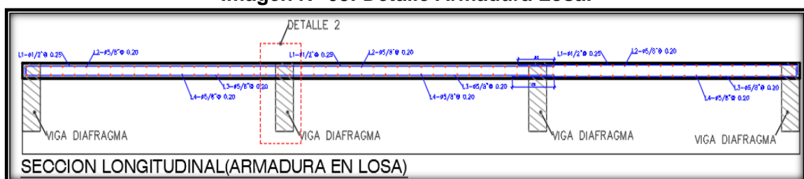
Imagen N° 03: Detalle Armadura Losa.
