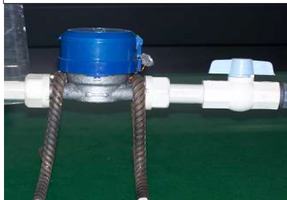
Figura N.º 02: Colocación de los anclajes
