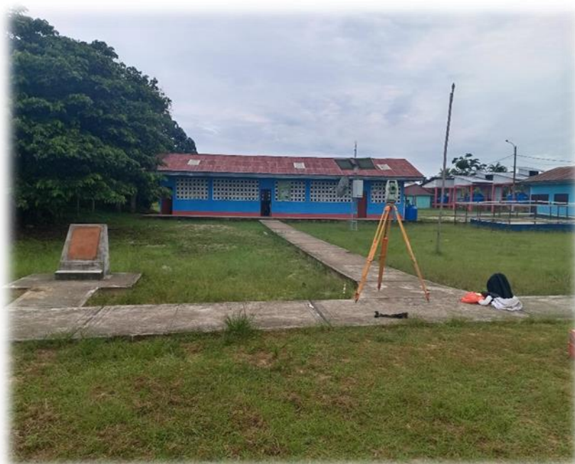
Foto N° 03: Vista de la localidad de El Lobo realizando levantamiento topográfico al detalle de veredas, lotes, buzones, etc
