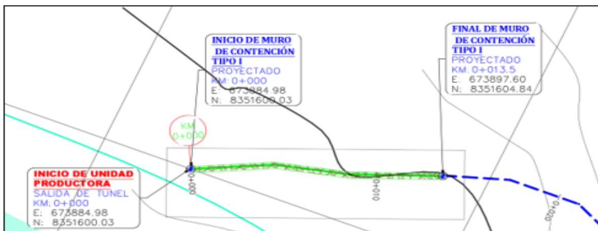
Imagen 1: Tramo de muro de contención Tipo I.
