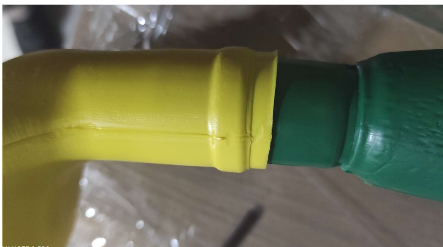
Foto referencial (embone a presión de boquilla)
