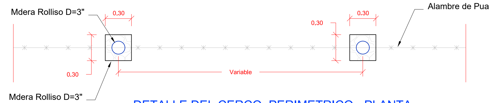
DETALLE DEL CERCO PERIMETRICO - PLANTA ESCALA: 1/50
