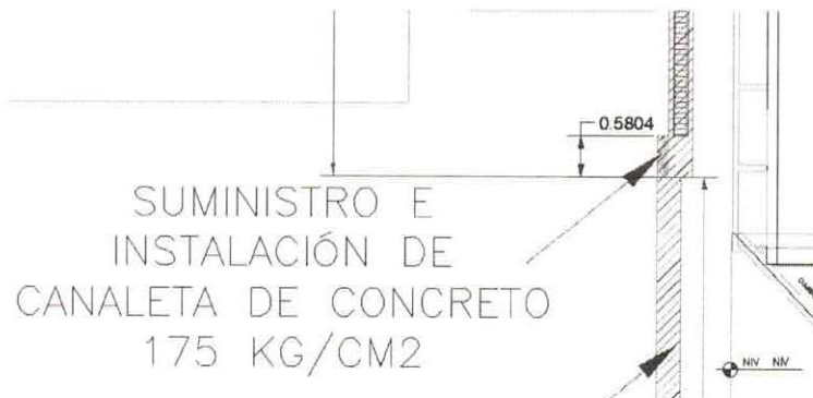
Imagen 18: Sardinel peraltado con resistencia de 175 kg/cm 2 para cerramiento de sistema pluvial de piso del HAPCSR II-2
