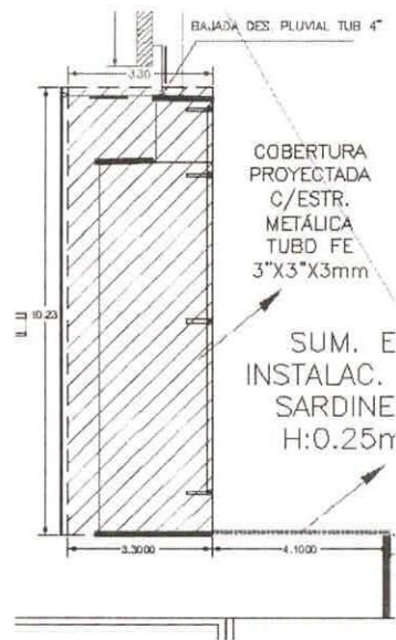
Imagen 19: Suministro e instalación de muro tipo drywall para cerramiento entre el muro existente y la cobertura tipo calaminon de ambiente de Emergencia Gineco Obstétrica
