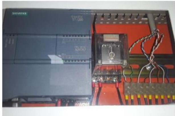
PLC instalado en el Tablero de monitoreo remoto
