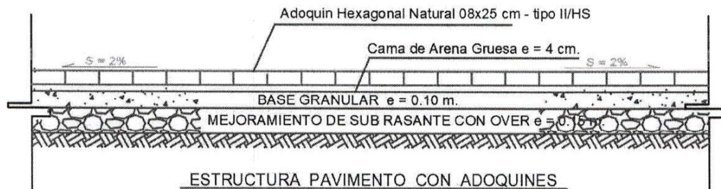
Sección típica de la estructura del pavimento.
