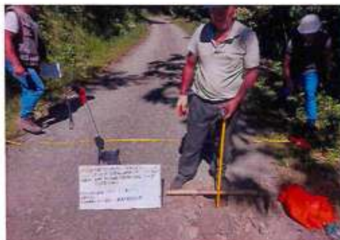
Foto 03: Verificación del espesor existente de afirmado E= 0.02 mts
