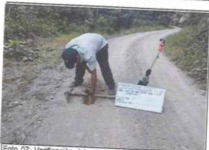
Foto 07: Verificación del espesor existente de afirmado E= 0.025 mts
