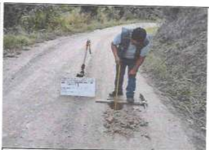
Foto 16: Verificación del espesor existente de afirmado E=0.00 mts
