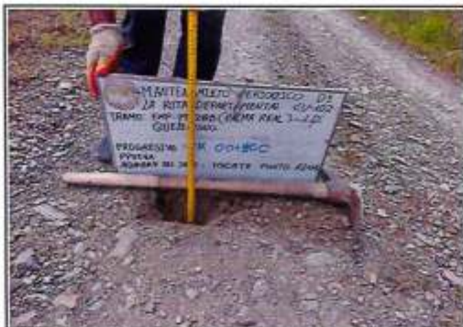
Foto 01: Verificación del espesor existente de afirmado E= 0.03 mts
