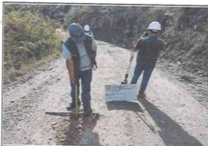
Foto 17: Verificación del espesor existente de afirmado E=0.03 mts
