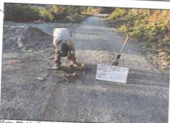
Foto 09: Verificación del espesor existente de afirmado E= 0.025 mts
