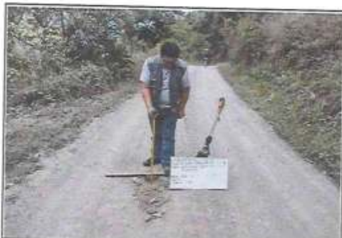
foto 13: Verificación del espesor existente de afirmado E=0.01 mts
