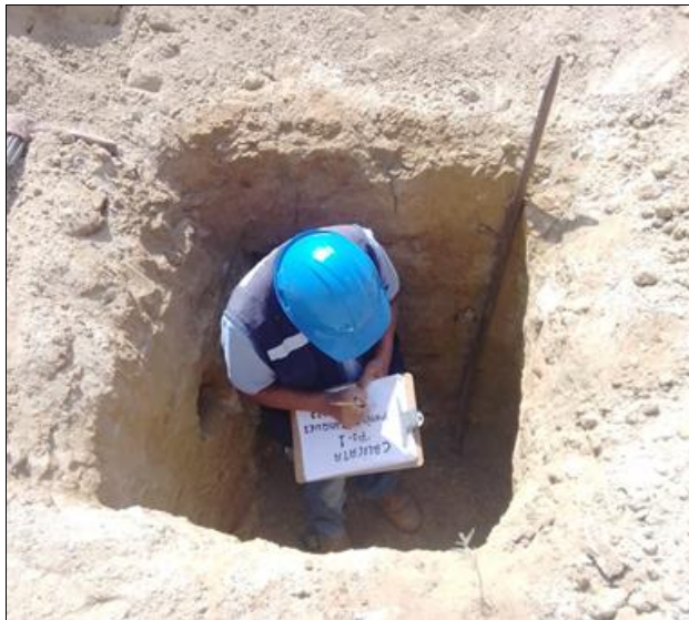
Imagen 4 Calicata PS-1 Inicio de Tramo de drenaje
