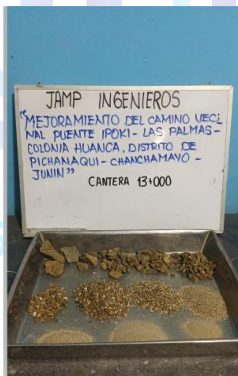
Foto N° 02: Cantera 01. Ensayo de laboratorio (Granulometría)
