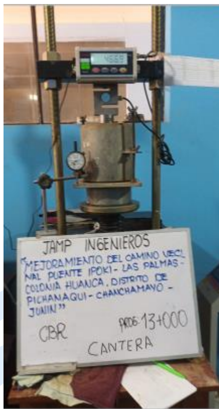
Foto N° 03: Cantera 01. Ensayo de laboratorio (CBR)
