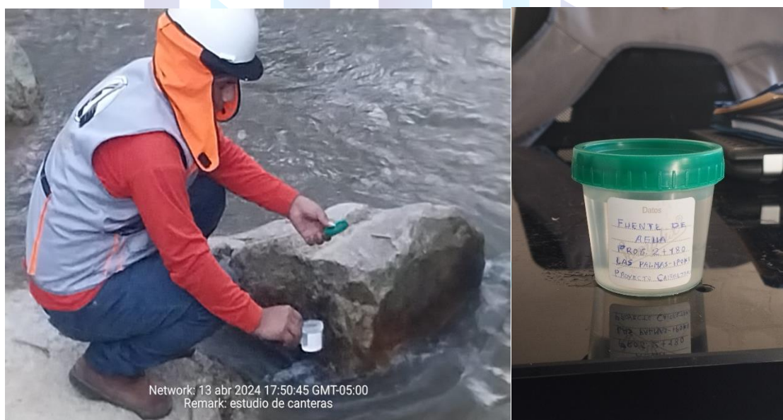
Foto N° 04: Extracción de muestras de la progresiva 2+180 para los ensayos químicos en agua.
