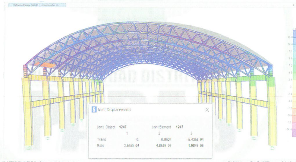
Figura N°31: Vista de los desplazamientos debido al viento "Y" en el programa SAP2000 V20.0.0
