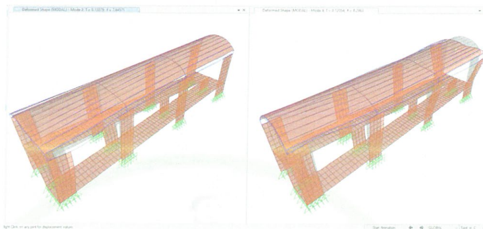
Figura N°21: Modo de vibración 3 y 4, con un periodo fundamental de T_3=0.1353 y T_4=0.1136 respectivamente.
