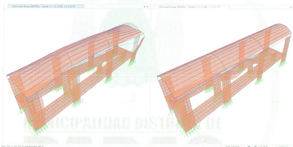
Figura N°22: Modo de vibración 5 y 6, con un periodo fundamental de T_5=0.0957 y T_6=0.08976 respectivamente.
