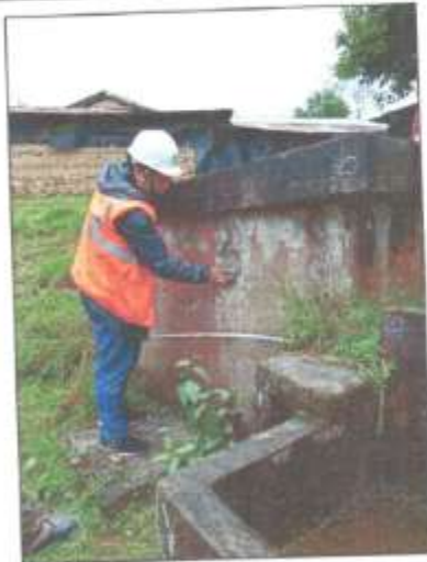
Realización del ensayo de esclerómetro.
