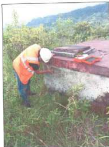
Realización del ensayo de enterrómetro.
