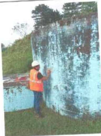
Realización del ensayo de esclerómetro.
