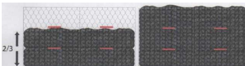
Posición de los tensores en Gavión.
