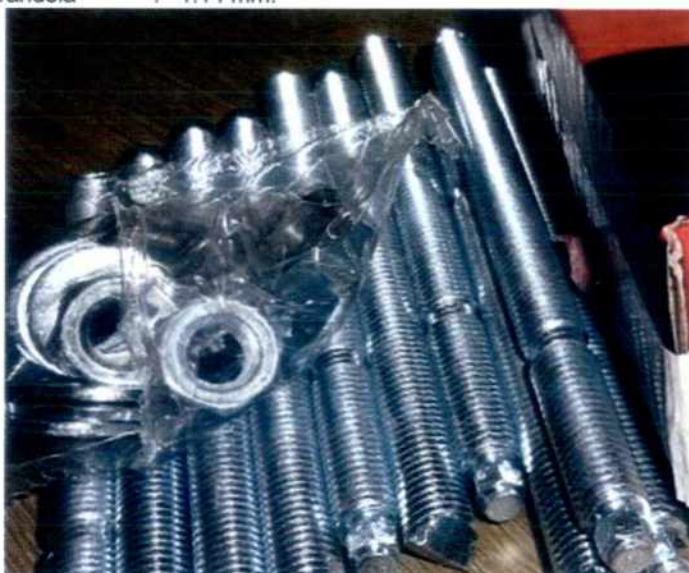
Detalle de pernos de anclaje M16- 5/8, tuercas y arandelas
