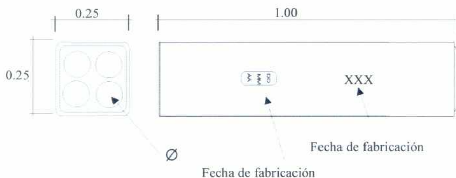
Detalles del ducto de 4 vías
