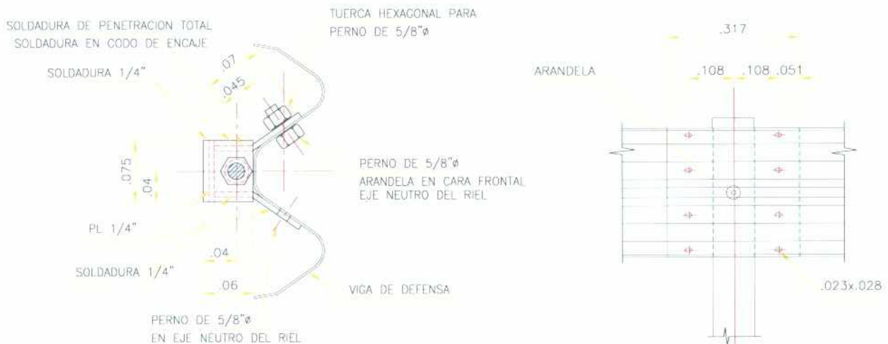
Detalle de conexiones de guardavías y accesorios
