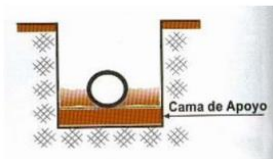
Ilustración 3: Tubería en cama de apoyo
