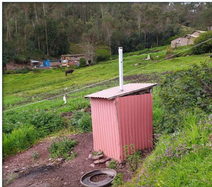
Imagen N° 80 Sistema de excretas sin funcionamiento – Villa la Libertad
