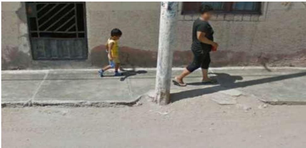
Ilustración N° 21. CALLE ELIAS AGUIRRE - Cuadra 03– margen, Izquierdo, Vereda de tránsito peatonal en mal estado con presencia de grietas y sin respetar criterios técnicos, de acuerdo a la evaluación realizada en campo.
